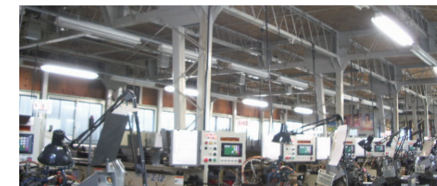
照明を2/3間引いた現在の工場内。今後は照明の位置を下げて作業者の手元を個別に照らすなどの工夫で、作業しやすい環境を整えたい
