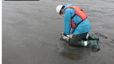
小型の採泥器を用いて干潟で直接採泥を行った。底質が締まって固いため、採泥器が砂に食い込みにくい。
