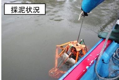
水深が浅く、底質が細砂主体であるため、20kg程もある重いスミスマッキンタイヤ型の採泥器を使用した。
