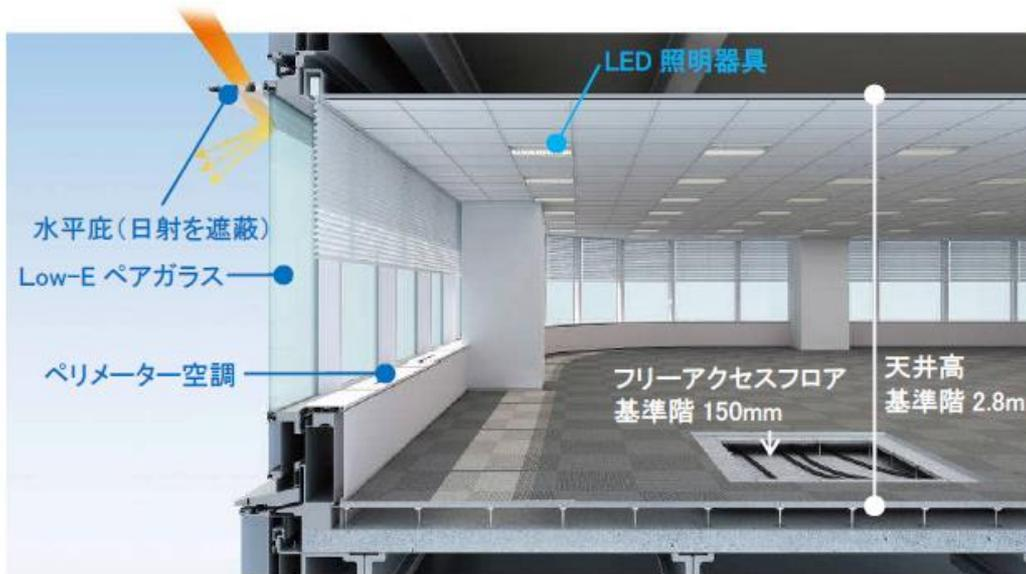
VAVユニット単位（約50m<sup>2</sup>）にて温度調整が可能
