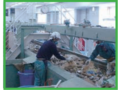
▲機械処理工程前の徹底した前処理作業
